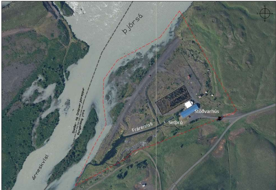
Mynd 5.2 Fiskeldisstöðin Laugum. Svart skáletrað svæði sýnir fyrirhugaða yfirbyggingu yfir ker sem nú standa utandyra. Rauð brotalína sýnir lóðamörk.
