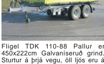
Fligel TDK 110-88 Pallur er 450x222cm Galvaniseruð grind. Sturtur á þrjá vegu, öll ljós eru á henni til skráningar, breið burðardekk 355/60 R18 16 PR. Verð 2.400.000 + vsk.
